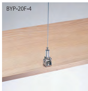
棚板などに6ミリの穴をあけ、ナットで固定します。本体部をピンで取付けた後、ワッシャをはめ込んで抜けないようにします。取付け板厚は10ミリまでです。
